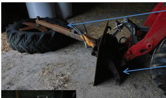
Barre d'attache en 10\*10 cm et de 1m50 de long (permet une bonne visibilité à l'avant). Si plus long : attention au porte à faux lors des déplacements
