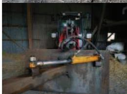
Un vérin hydraulique relié au tracteur pour avoir la commande en cabine. Cela permet de repousser à droite ou à gauche s'il n'est pas possible de faire demi-tour en bout d'allée. Adaptateurs et flexibles à acheter.
